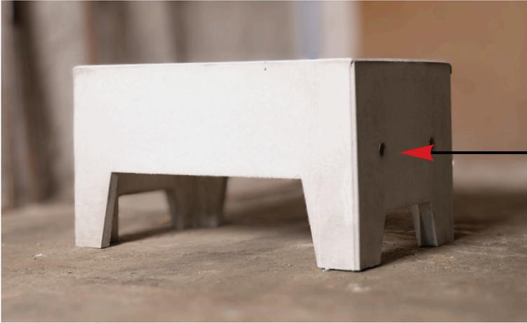
Die seitlichen Öffnungen am bewehrten Betonunterbau für die Wärmepumpe sind für einen einfacheren Transport und die Handhabung des Produkts ausgelegt. Durch diese Öffnungen können Eisenstangen eingeführt werden, die das Bewegen und Umsetzen des Unterbaus während der Montage erleichtern. Lochdurchmesser 40mm.
